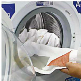
Laboratorní expert vkládá do pračky prádlo, na kterém je připevněná testovací náplň s různorodými typy skvrn.
