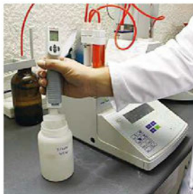
Efektivitu máchání jsme zjišťovali analýzou vody odstředěné ve speciální odstředivce.
